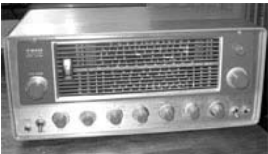
ER-202 sedd framifrån. Avstämning med två rattar, vill man ha bättre selektivitet blir det till att använda ytterligare två rattar då man kopplar in Q-multiplikatorn...
