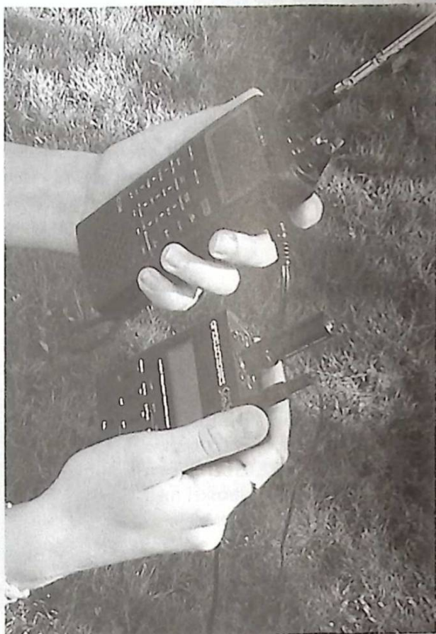
Med hjälp av en Optoelectronics Scout detekteras en sändare och den aktuella frekvensen ställs in automatiskt på R20.
