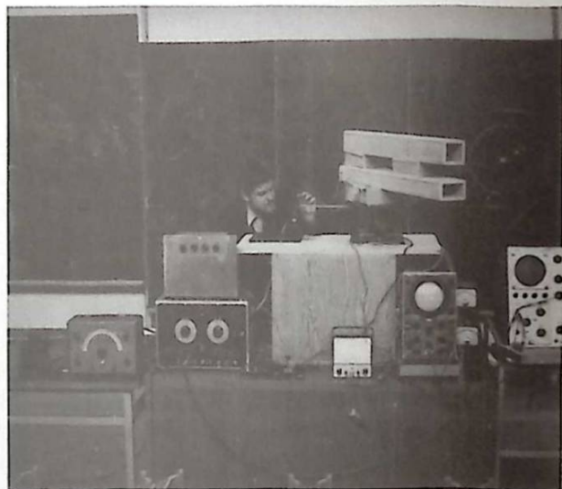
Eie demonstrerar den egenhändigt konstruerade radaranläggningen med PPI-indikator
