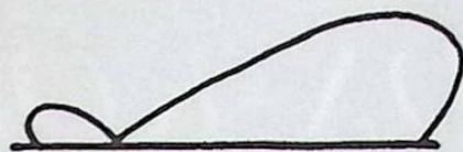
Figur 4. Vertikalt strålningsdiagram för Beverageantenn
