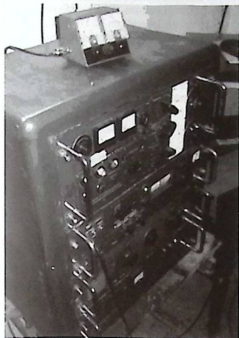
Sändaren från Radio Zodiac 6325 kHz, Rhode & Schwartz sk-010, 100 watt
