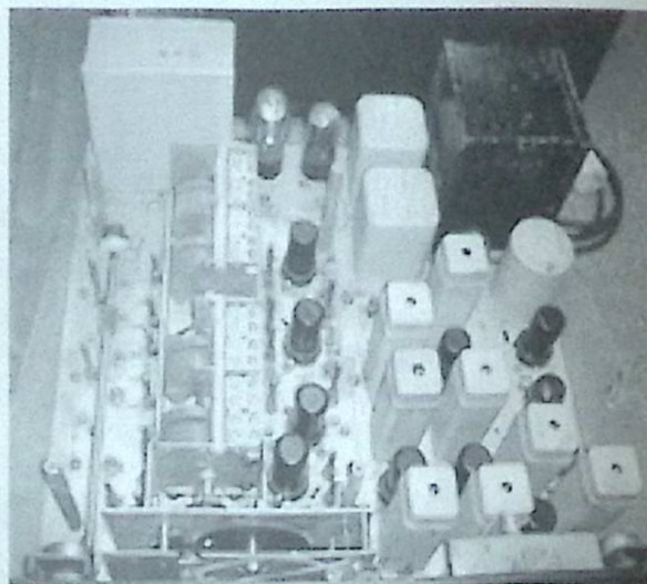
AR88D chassie sett framifrån. Lägg märke till de kraftiga transformatorerna och drosslarna. En yttreskärmbåda över HF/osc/blandarstegen samt en inre skärm över den 4-gangade vridkondensatorn är borttagna.
