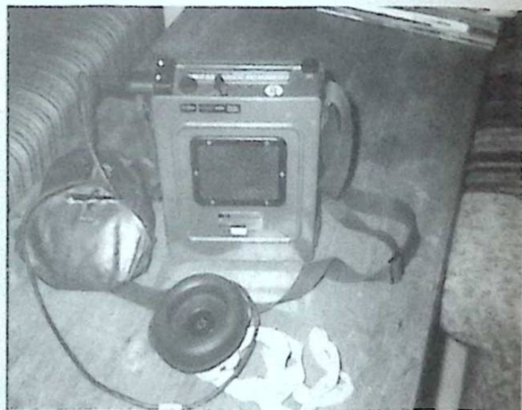
Mottagaren Mt910. Luformottagare, har tregangad vridkonding och HF-steg. En mycket bra portabel AM-mottagare, LV och MV.
