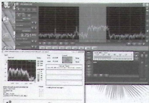
Figur 5. Avlyssning av Vatikankrations DRMsändning med en kommersiell DRM-mjukvara som körs samtidigt som Perseus egen.
