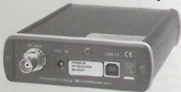
Figur 3: Mottagarens bakpanel har enbart tre kontakter för att ansluta matningsspänning, dator och antenn.
