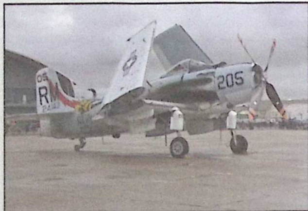
En Douglas A10 Skyraider från hangarfartyget Saratoga med vikbara vingar för att kunna hissas ner under däck.
