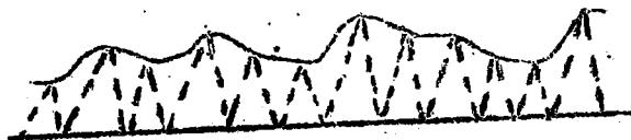
Den pulserande spänningen utjämnas med kondensatorn C i mottagaren.
