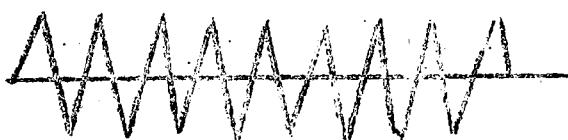
Den unmodulerade vågen från sändaren.
